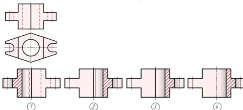
9. По заданным видам определить название каждого вида согласно проекционной связи
